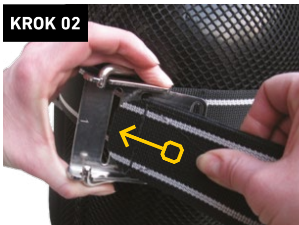
Rys. 13. Instalacja pasa butli
