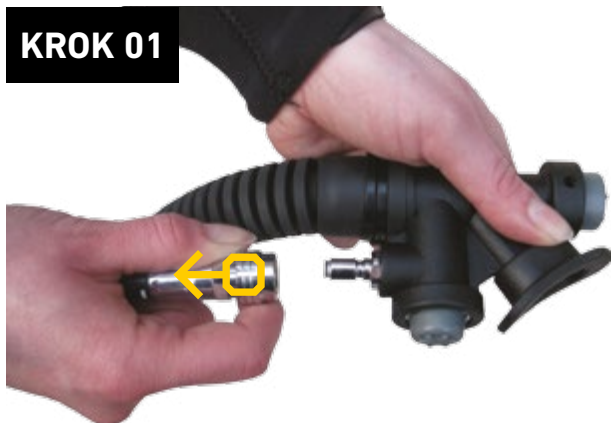
Rys. 21. Podłączenie węża LP
