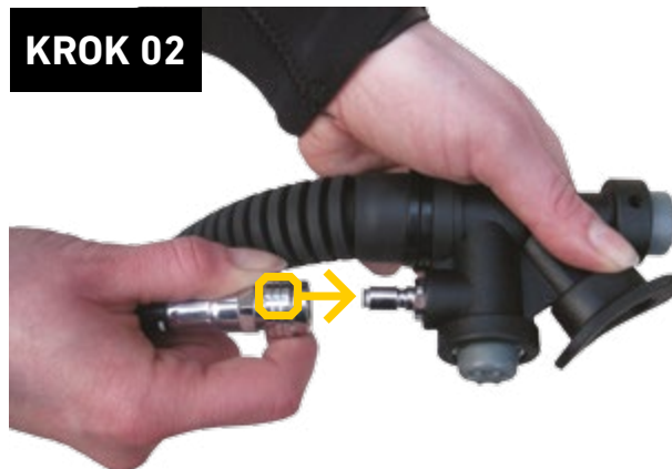
Rys. 22. Podłączenie węża LP
